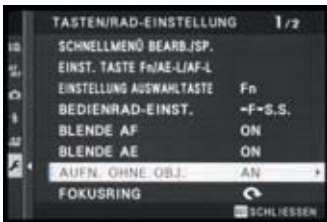
▲ Auslösen ohne Objektiv aktivieren, falls die X-T20 mit einem angeschlossenen Adapter nicht auslöst.
