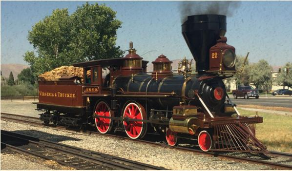
Die „Inyo“ der Virginia and Truckee Railroad ist eine 2'B-Dampflokomotive, 1875 von den Baldwin Locomotive Works gebaut. Sie wurde sowohl im Personen- als auch Güterverkehr eingesetzt. 1877 wurde sie mit Druckluftbremsen ausgestattet und 1910 von Holz- auf Ölfeuerung umgebaut.
