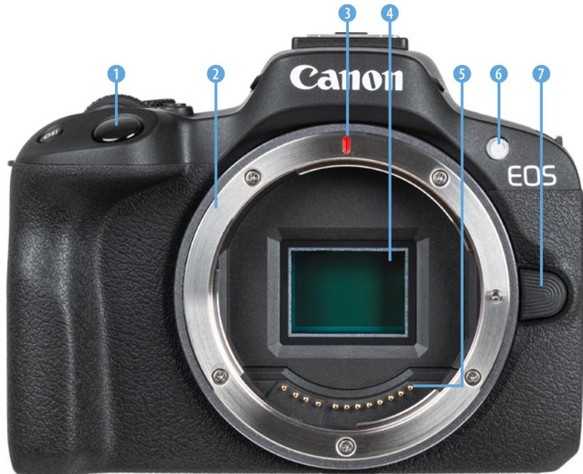
Im Innern des Kamerabajonetts befindet sich der **Sensor** ④, der die Bilder mit einer Auflösung von 24,2 Millionen Pixeln auf einer Fläche von 22,3 mm × 14,9 mm aufnimmt. Achten Sie beim Objektivwechsel darauf, die Kamera nach unten zu neigen, sodass möglichst kein Staub auf den Bildwandler gelangt.
