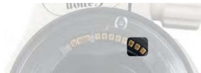
◀ Canon-L-Objektiv mit den drei Zusatzkontakten für Telekonverter.
