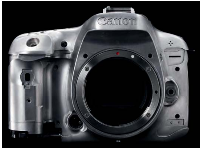
▲ Das Gehäuse Ihrer 7D Mark II ist durch die Magnesiumlegierung leicht und robust zugleich, zudem wurden die Dichtungen gegen Staub und Spritzwasser weiter verbessert (Bild: Canon).
