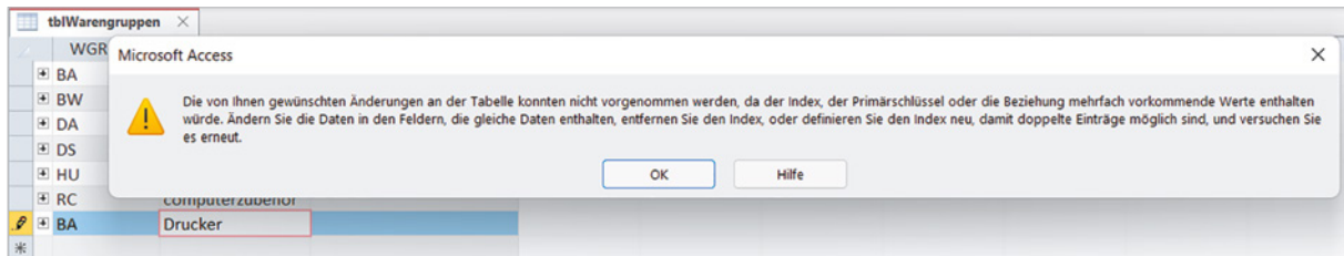
Bild 4.4 Mehrfach vorkommende Werte im Primärschlüssel
