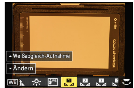
▲ Einen der vier Speicherplätze des manuellen Weißabgleichs aufrufen und die Weißabgleich-Aufnahme starten.
