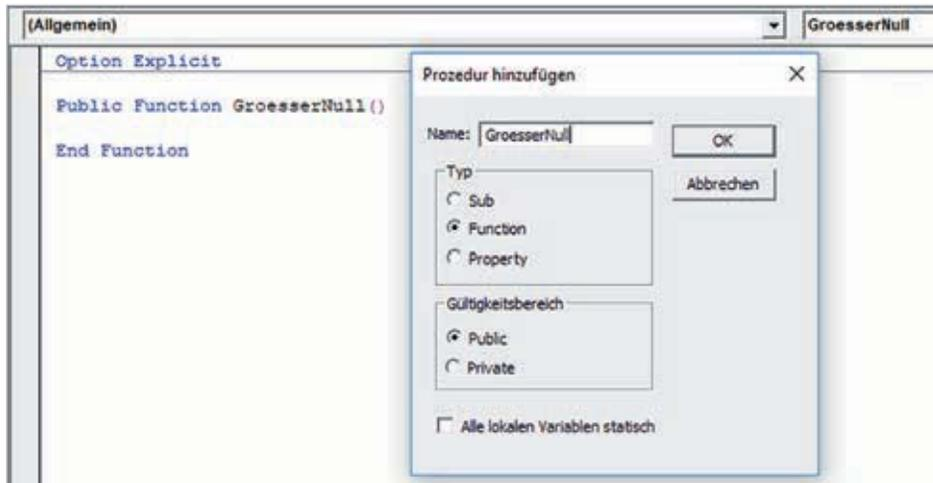
Bild 3.62 Funktion einfügen
