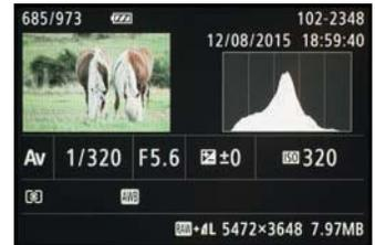
▲ Histogrammanzeige bei einer optimalen Belichtung eines kontrastreichen Motivs
