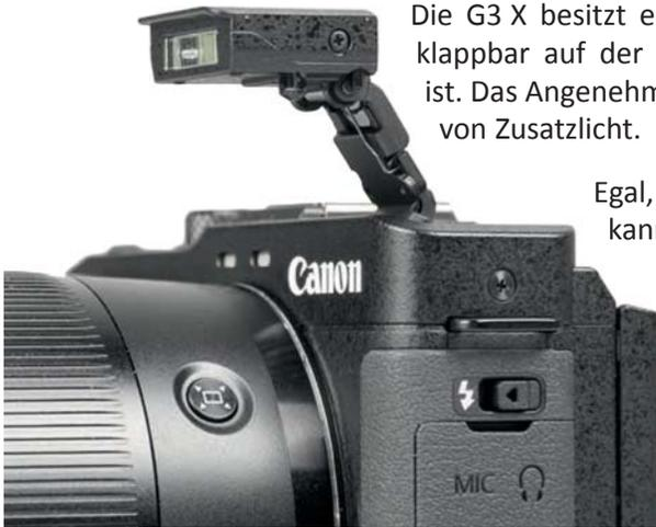
Die G3 X besitzt einen fest eingebauten Blitz, der ausklappbar auf der linken Gehäuseoberseite positioniert ist. Das Angenehme daran ist die ständige Verfügbarkeit von Zusatzlicht.
