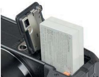
▲ In der G3 X werden Lithium-Ionen-Akkus vom Typ NB-10L (7,4 V, 920 mAh) verwendet.
