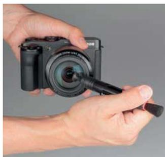
▲ Mit dem Lens Pen lassen sich Objektivverunreinigungen sicher und leicht entfernen.
