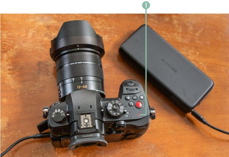
▲ Aufladen des Akkus mit einer Powerbank (hier RAVPower PD 60W Powerbank USB C Power Delivery 20000 mAh).
