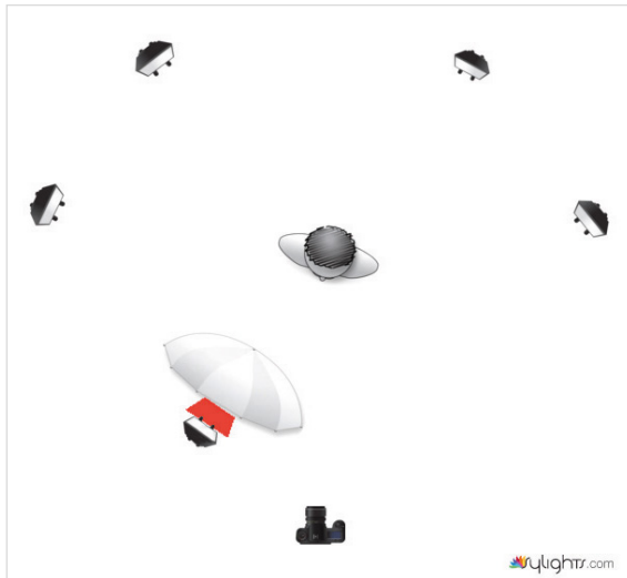
Abb. 38 | Das symbolische Diagramm zum Setup zeigt die fünf Speedlights. Zwei dienen als symmetrische Kicker von links und rechts, zwei als Gegenlichtspots von hinten, eines kommt von vorne durch einen weißen Schirm und ist mit einem Rotfilter ausgestattet.
